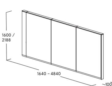
Configuration linéaire avec raccordement au mur du bâtiment
